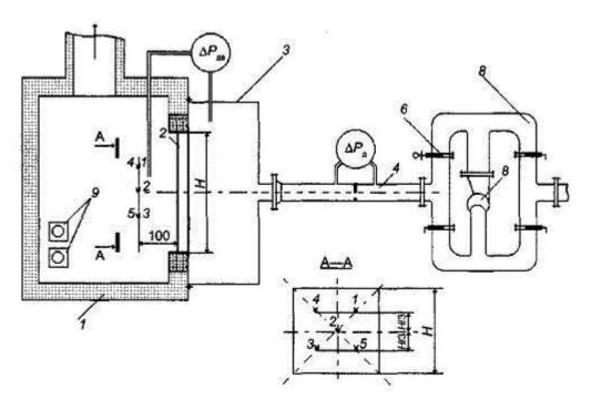
1 - печь; 2 - испытываемый образец двери; 3 - пневмокамера; 4 - стенд определения расходных характеристик инженерного оборудования; 6 - регулирующая заслонка; 7 - воздуховоды обвязки стенда; 8 - вентилятор; 9 - форсунки;
